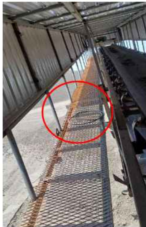
รูปที่ 8 ระบบสเปรย์น้ำบริเวณจุดที่เกิดฝุ่นละอองทั้งภายในและรอบบริเวณโรงโม่หิน
