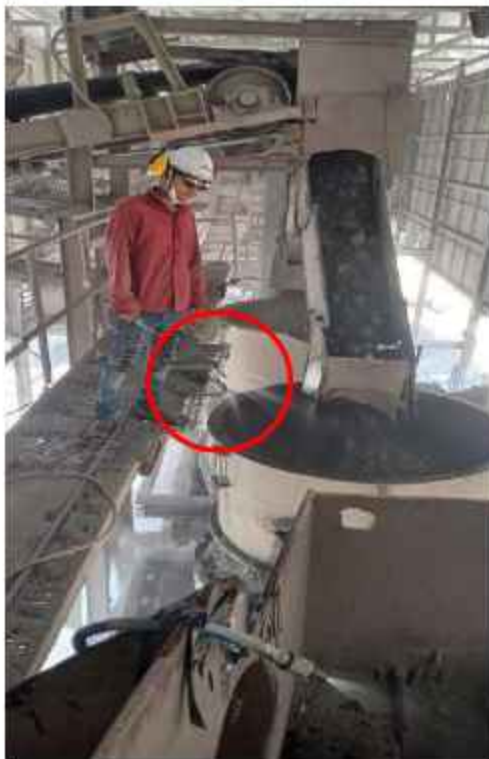
รูปที่ 8 ระบบสเปรย์น้ำบริเวณจุดที่เกิดฝุ่นละอองทั้งภายในและรอบบริเวณโรงโม่หิน
